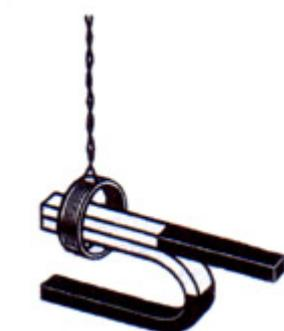
Магнитное поле тока взаимодействует с магнитным полем магнита по закону: *разноименные магнитные полюсы притягиваются, одноименные – отталкиваются*
